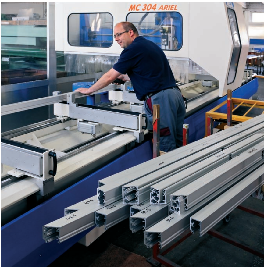
Blick in das Bearbeitungszentrum der SIO AG: Bohren, schneiden, fräsen auf einer einzigen – ultramodernen – Anlage.
